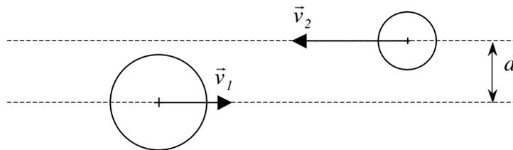
Les vitesses finales dépendent de la distance  $d$  entre les supports des deux vecteurs vitesses initiales. Cette distance est appelée **paramètre d'impact**.
