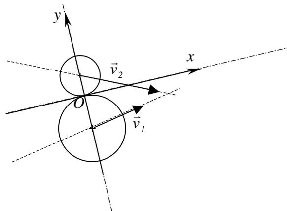
Nous choisissons un système de coordonnées polaires. Les vitesses initiales seront donc déterminées par leur norme  $v$  et leur orientation  $\theta$  par rapport à l'un des axes du repère (celui perpendiculaire à la ligne d'impact), comme indiqué sur la figure ci-dessous :
