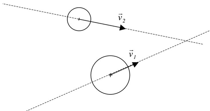
L'énergie cinétique d'un corps solide (se déplaçant dans un plan) est égale à la somme de l'énergie cinétique de translation de son centre de masse et de l'énergie cinétique de rotation du corps autour d'un axe perpendiculaire au plan et passant par son centre de masse :
