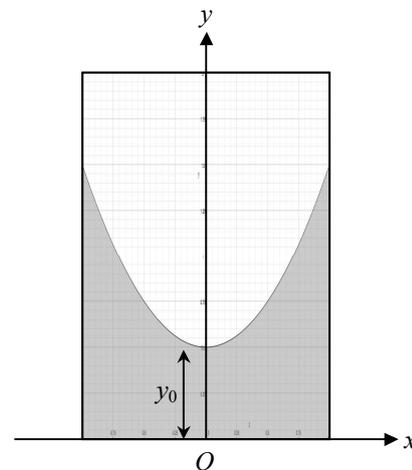
Quand le liquide est immobile, sa surface libre est un plan situé à une distance  $h$  du fond du récipient. L'équation (1) ne donne aucune information quant à la valeur de  $h$  ; autrement dit, nous ne savons pas où se positionne le parabololoïde de la surface du liquide en rotation, par rapport au plan du liquide immobile. Appelons ce plan le **plan initial** et cherchons sa position par rapport au parabololoïde.
