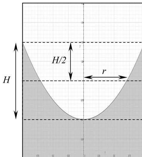
L'intersection du paraboloïde et du plan initial est un cercle de rayon  $r$  (c.f. fig. ci-dessus). Recherchons maintenant ce rayon. Il doit satisfaire la condition :
