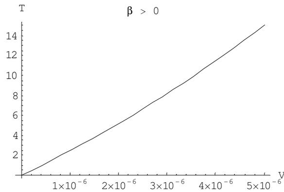
Figure 7 : Température du gaz en fonction de son volume sur une petite plage de température
