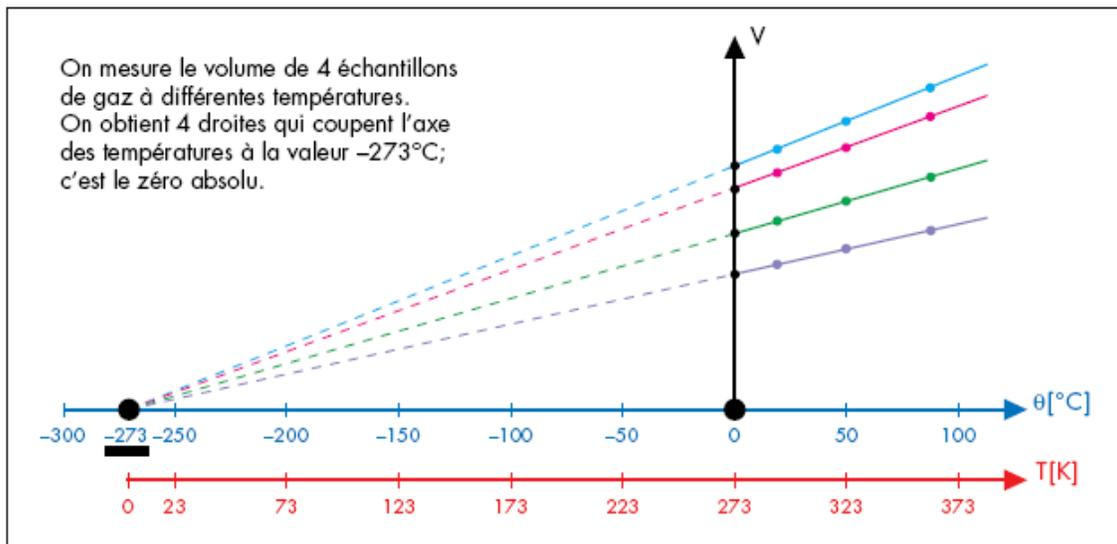
Figure 4 : Volume d'un gaz parfait en fonction de sa température
