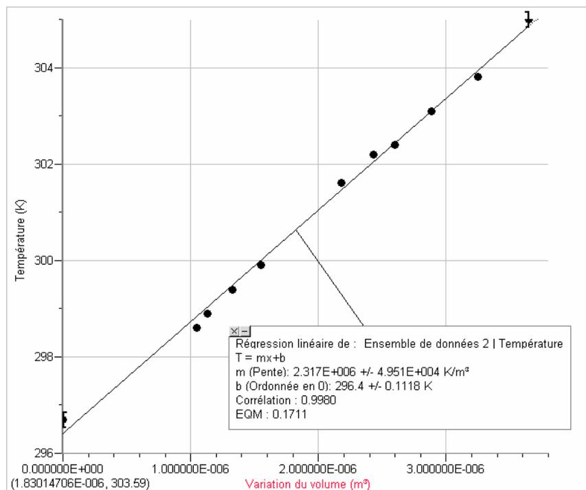
Figure 2 : Température du gaz en fonction de sa variation de volume
