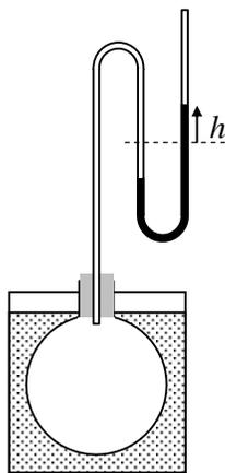
Figure 5 : Déplacement du liquide dû à la dilatation du gaz
