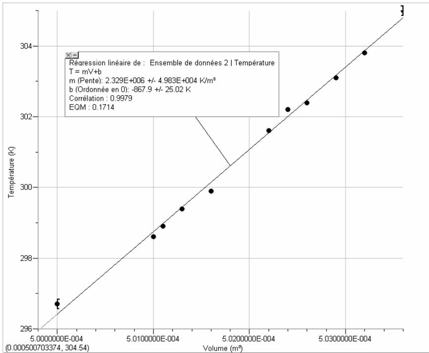
Figure 3 : Température du gaz en fonction de son volume
